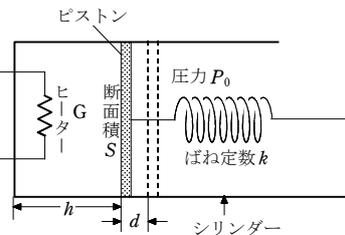
理想気体  $G$  をヒーターでゆっくり加熱すると、図の破線のように、ピストンが距離  $h$  の位置から右へ距離  $d$  移動した。気体定数を  $R$  として、次の問いに答えよ。解答は、 $P_0$ ,  $h$ ,  $S$ ,  $R$ ,  $d$  および  $k$  のうち必要な記号を用いて表すこと。
