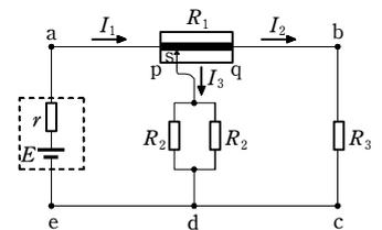
回路の各部分を通る電流を  $I_1$ 、 $I_2$  および  $I_3$  とし、それらの向きを図のようにとると、電流の保存則(キルヒホッフの法則 I)より、接点  $s$  において
